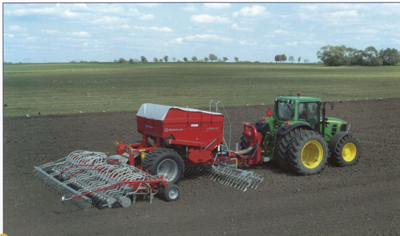
Överum Combi Jet utrustad med såmaskinshjul i dimension 800/45-30.5 T423 och packarhjul i dimension 23x8.50-12 T463 från Trelleborg.
