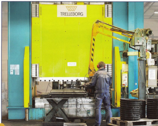
Fälgdysken "klipp" och pressas med en kraft på 3 000 ton.
